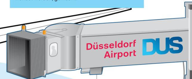
Während der Standzeit am Boden werden die Flugzeuge mit Strom versorgt. Bei einer Fingerposition direkt am Terminal, wie hier, kommt die Versorgung über die Brücke. Auf Außenpositionen wird eine Elektroaggregat zum Flieger gezogen und angeschlossen. Beides erledigt der Bodenabfertiger.
