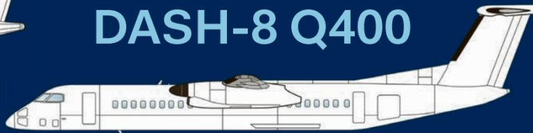
Die ATR-72, die etwas kürzere ATR-42 und die Dash-8 Q800 sind Turboprops und ähnlich von der Konstruktion. Alle sind sogenannte Hochdecker, das bedeutet, der Rumpf hängt unter den Tragflächen. Trotz ähnlicher Merkmale sind die Flugzeugtypen an der Form leicht zu unterscheiden: Die etwas größere Q400 ist eckiger, was besonders beim Leitwerk deutlich auffällt. Außerdem hat dieses Muster nur vier Cockpitfenster, die ATRs jeweils sechs.
